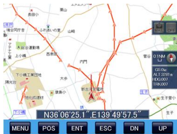
送電線・鉄塔表示画面
