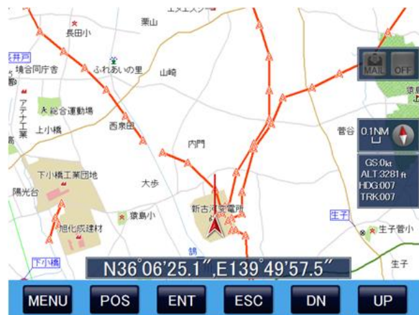
送電線・鉄塔表示画面
